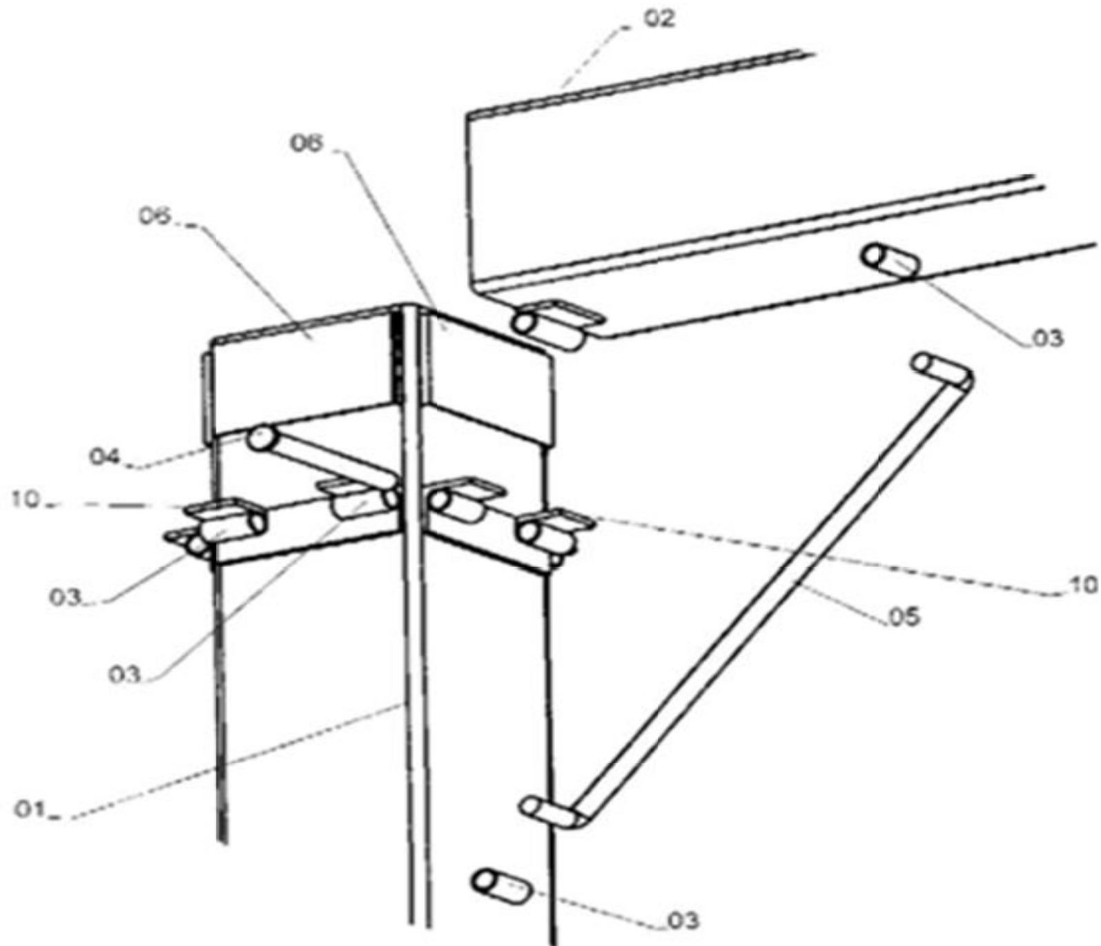
Figura 3 - Exemplo de detalhe de conexão de estrutura
