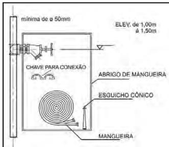
Figura 17: Detalhe de hidrante
