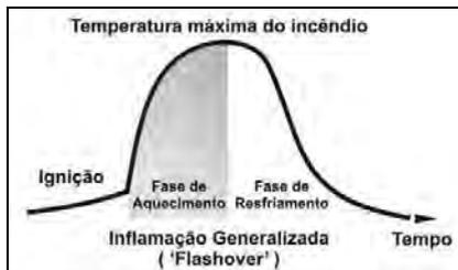
Figura 03: Curva temperatura - tempo de um incêndio
