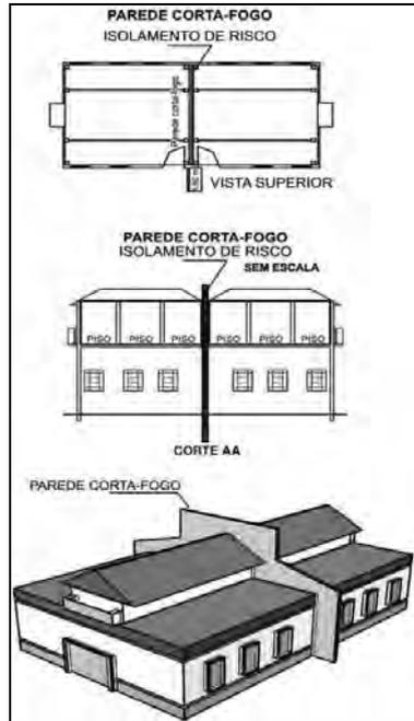
Figura 09: Isolamento obtido por parede corta-fogo
