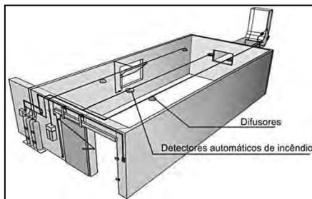
Figura 26: Sistema de CO<sub>2</sub>
