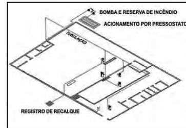
Figura 19: Perspectiva isométrica de sistema de hidrantes
