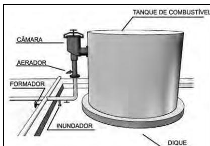
Figura 25: Detalhe de câmara de espuma
