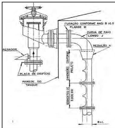
Figura 23: Sistema fixo de espuma
