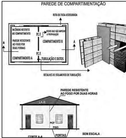
Figura 10: Detalhes de parede de compartimentação
