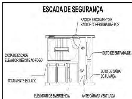
Figura 15: Escada e elevador à prova de fumaça
