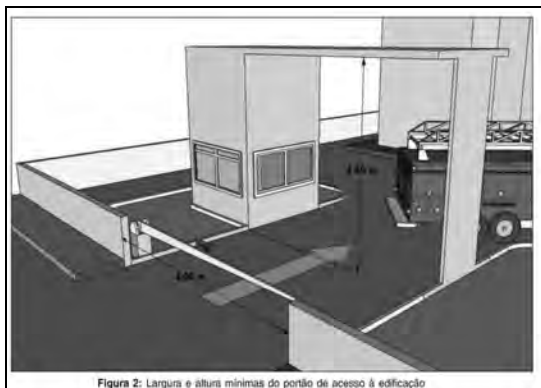
Figura 2: Largura e altura mínimas do ponto de acesso à edificação
