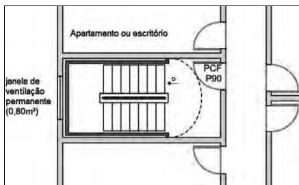
Figura 7: Escada enclausurada protegida
