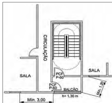
Figura 11: Escada enclausurada do tipo PF ventilada por balcão
