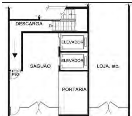
Figura 16: Descarga através de hall térreo não enclausurado
