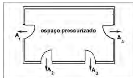
Figura 1: Trajetórias de escape do ar em paralelo
