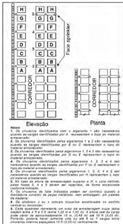
Figura 5.3.4.4.1.1(d): Distribuição de chuveiros internos, mercadorias Classe I, Classe II ou Classe III, altura de armazenagem acima de 25 ft (7,6 m) - Opção 1.
