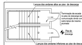
Figura 3 - Segmentação das escadas no piso da descarga.
