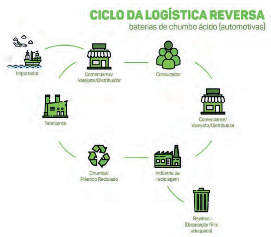
Figura 15. Ciclo do sistema de logística reversa de baterias chumbo-ácido.
