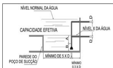
Figura B.1: Tomada superior de sucção para bomba principal
