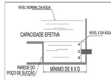
Figura B.2: Tomada lateral de sucção para bomba principal
