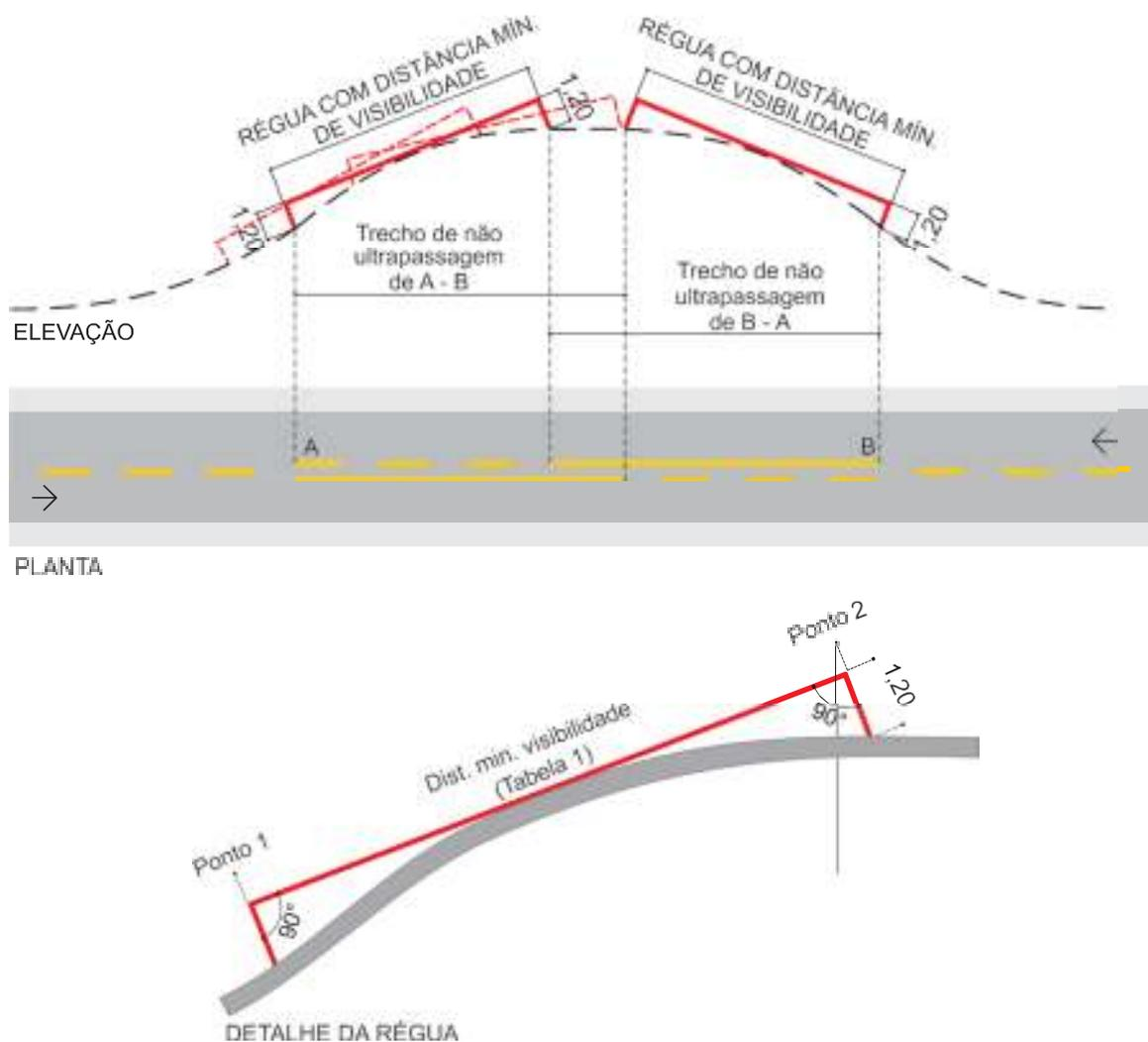
**FIGURA 1: Distância de Visibilidade de Ultrapassagem – Vertical.**
