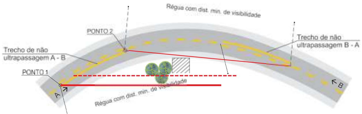
**FIGURA 2: Distância de Visibilidade de Ultrapassagem – Horizontal.**
